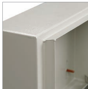
В исполнении IP54 многогранный защитный желоб корпуса предотвращает проникновение грязи и воды при открытии дверцы.
