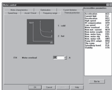
Настройка тепловой защиты с помощью ПО PowerSuite на базе ПК
