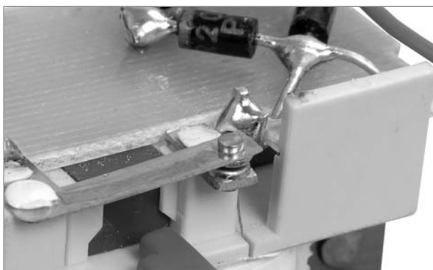
Дополнительный контакт коммутует обмотки катушки управления, снижая ток удержания в 5 раз по сравнению с пусковым.
