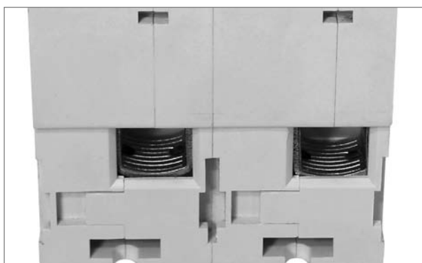
Насечки на контактных зажимах, за счет большей площади контакта, снижают переходное сопротивление между зажимом и проводником и тепловые потери в месте контакта.
