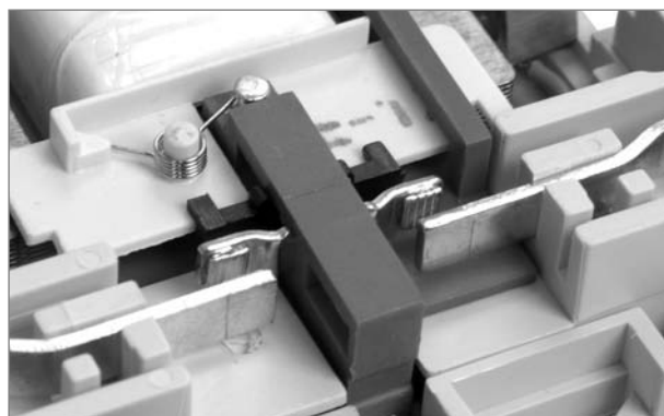
Мостиковый контакт обеспечивает высокие электроизоляционные свойства.
