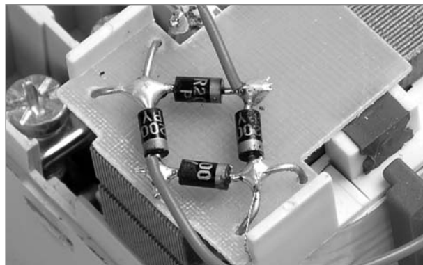
В цепи катушки управления установлен выпрямительный мост, позволяющий управлять катушкой постоянным током напряжением 220 В.
