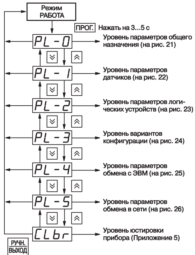
Рис. 19. Схема выбора уровня программируемых параметров
