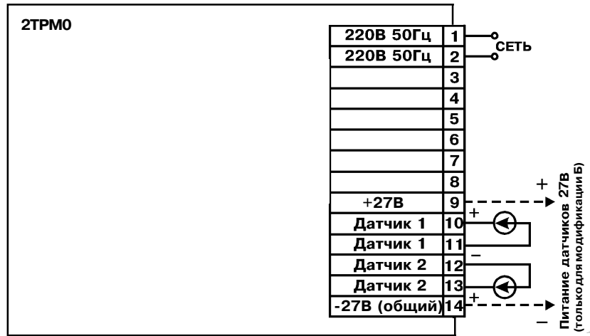
Рис. П2.3. Схема подключения к 2TRM2 датчиков с аналоговым выходным сигналом 0-20, 0-5 мА, 0-1 В
