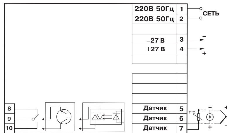
Рис. П2.8. Схема подключения прибора в DIN-реечном корпусе с ключевыми устройствами
