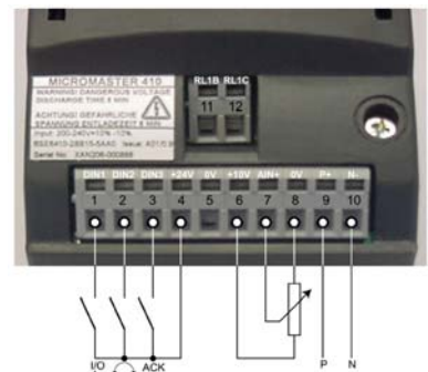
Блок-схема преобразователя MICROMASTER 410
