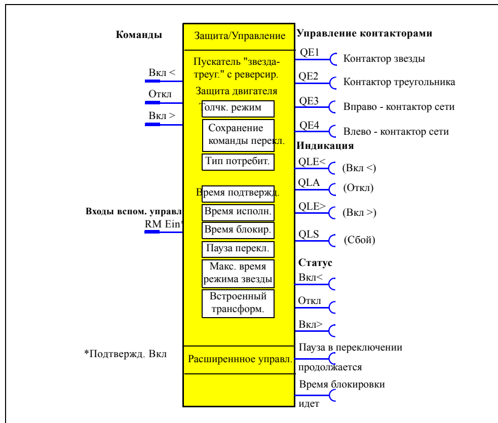
Рис. 4-15: Схема функции управления "Пускатель "звезда-треугольник" с реверсированием", функциональный блок "Защита/Управление"
