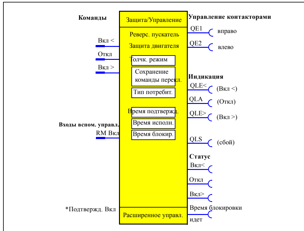
Рис. 4-12: Схема функции управления "Реверсивный пускатель", ФБ "Защита/управление"
