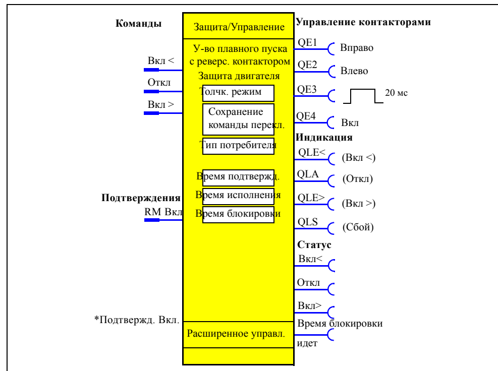
Рис. 4-24: Схема "У-во плавного пуска с реверсивным контактором", ФБ "Защита/Управление"
