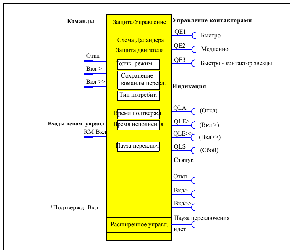
Рис. 4-16: Схема "Функция управления схемой Даландера", функциональный блок "Защита/Управление"
