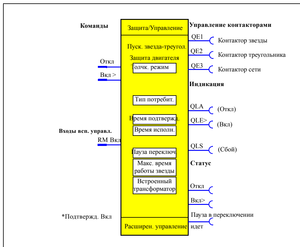
Рис. 4-14: Схема функции управления "Пускатель звезда-треугольник", функциональный блок "Защита/Управление"
