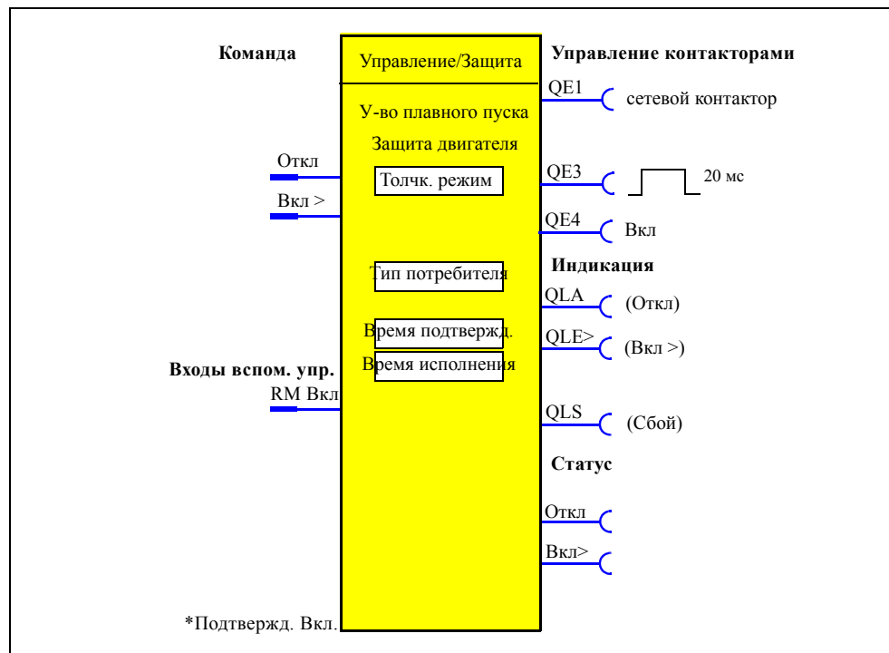
Рис. 4-23: Схема функции управления "У-во плавного пуска", ФБ "Защита/Управление"
