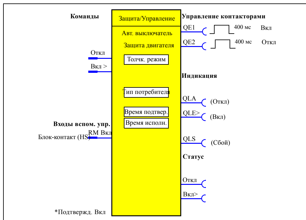
Рис. 4-13: Схема функции управления "Автоматический выключатель", функциональный блок "Защита /Управление"
