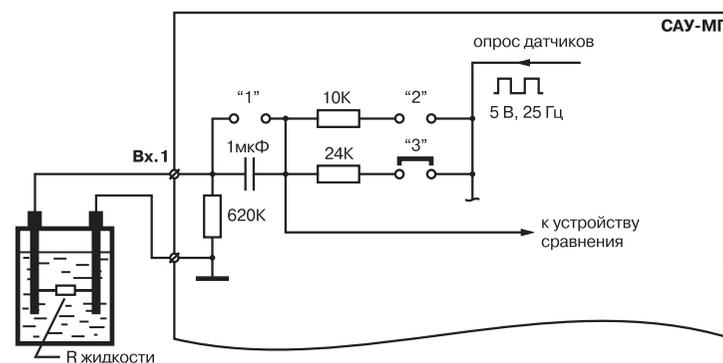
Рис. 4. Схема подключения кондуктометрического зонда (с расположением перемычек)
