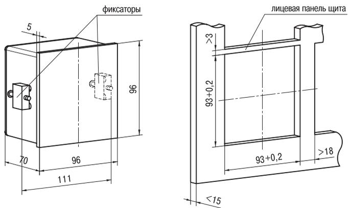
Рис. П1.2. Корпус щитового крепления типа Щ1
