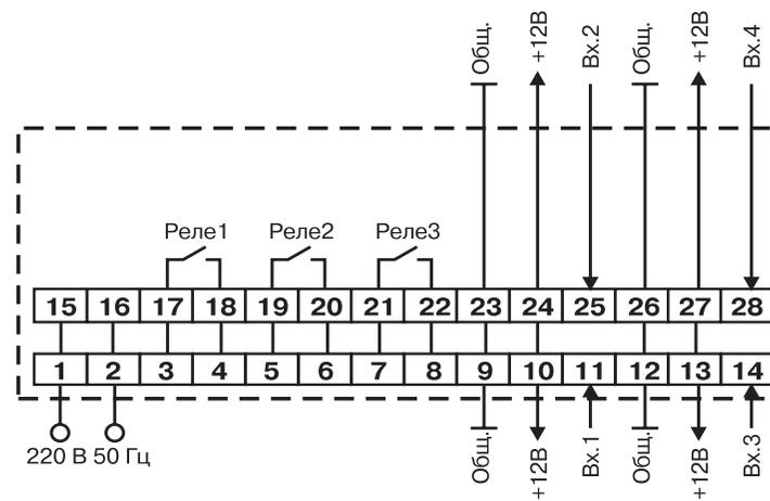
Рис. П2.1. Схема подключения прибора настенного крепления
