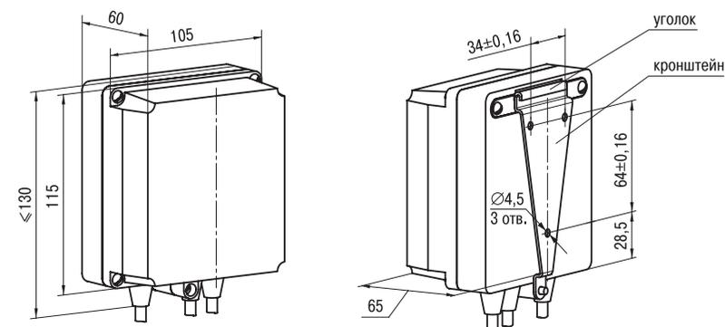
Рис. П1.1. Корпус настенного крепления типа Н
