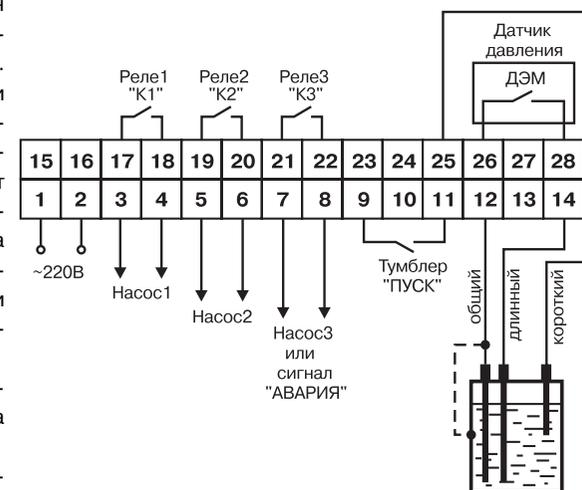
Рис. 40. Схема подключения САУ-МП для выполнения алгоритма 12
