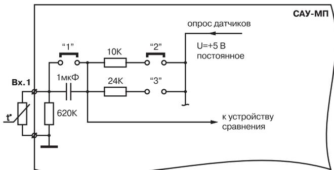
**Рис. 8. Подключение термисторов и позисторов**
