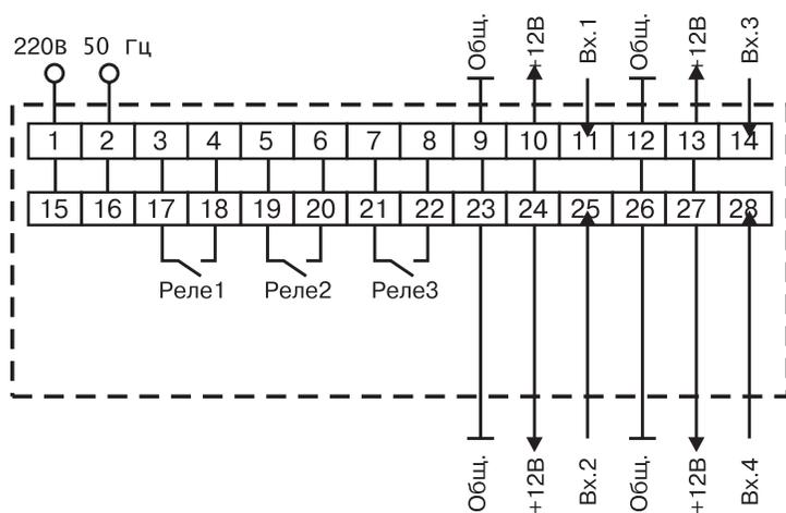
Рис. П2.2. Схема подключения прибора щитового крепления
